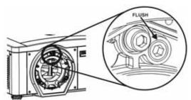
FIGURE 2-3 POSITION SETSCREW FLUSH
